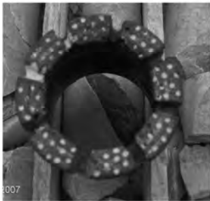
图 2 磨损后仿生金刚石钻头表面
