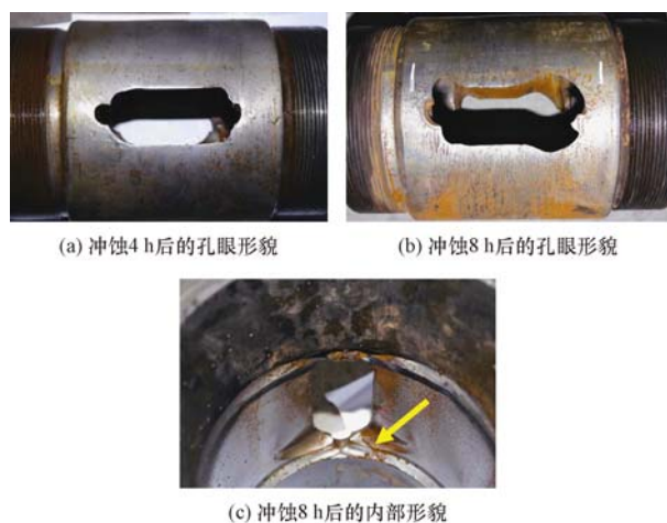
图7 2个孔眼的带孔短节冲蚀后的形貌
