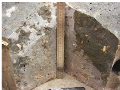
图 4 电弧脉冲压裂后井壁周围径向裂缝形态
