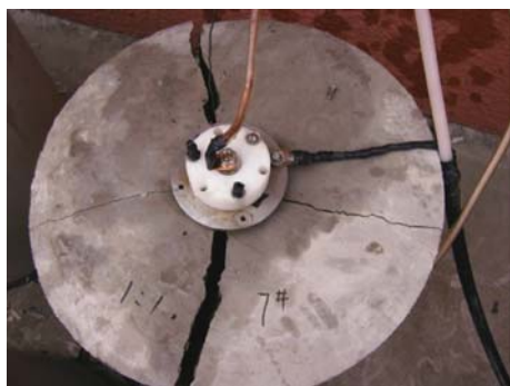
图 2 电弧脉冲压裂裂缝形态
