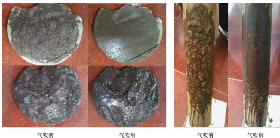
图 8 气吹前后岩心和钻具表面
