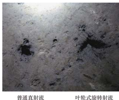
图 7 普通直射流与叶轮式旋转射流的破岩效果
