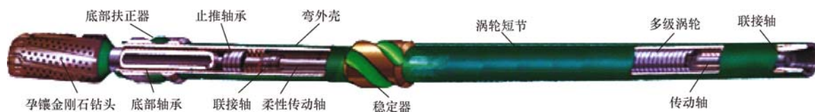
图 2 涡轮钻具结构
