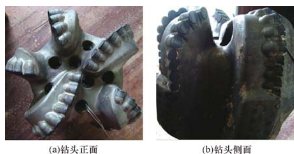
图8 第 1 只 \phi 311.1 mm EM1915S 型 PDC 钻头磨损情况
