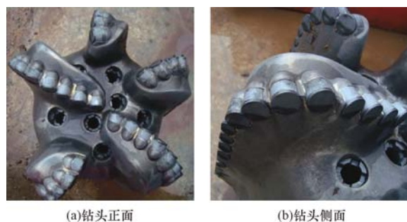
图9 第 2 只 \phi 311.1 mm EM1915S 型 PDC 钻头磨损情况
