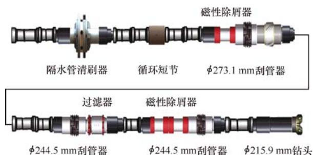
图 2 刮管洗井管柱组成
