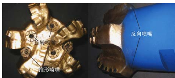
图 14 组合射流 PDC 钻头喷嘴分布
