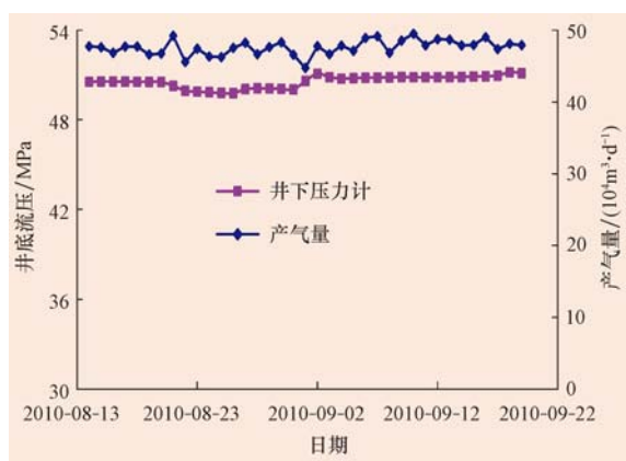
图6 调整后P井产气量和井下压力随时间的变化曲线
