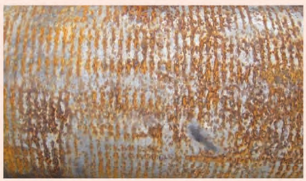
图 1 卡瓦在钻杆本体上形成的牙痕 Fig. 1 Slip mark on pipe body
