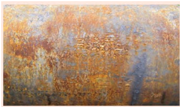
图 2 在钻杆接头部位形成的大钳牙痕
