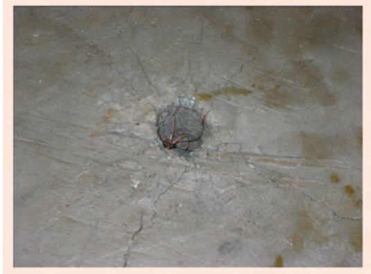
图 2 试验后裂纹分布 Fig. 2 Fracturing distribution after the test
