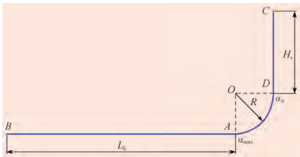
图 2 浅层稠油水平井井眼轨迹曲线
