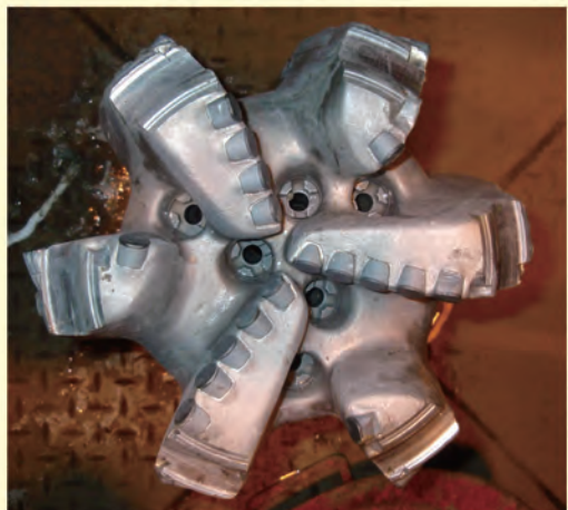
图1 NV-2井磨损严重的 \phi 311.1 mm Best PDC钻头
