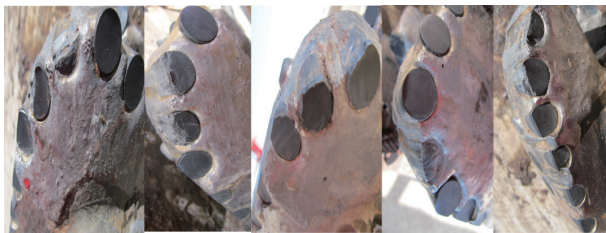
图9 邻井二开井段钻头使用情况（从左到右依次为1#~5#刀翼）
