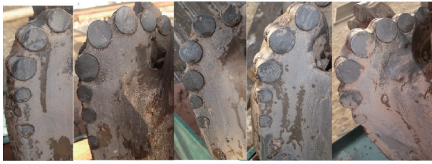
图8 M502-H2井二开井段钻头使用情况（从左到右依次为1#~5#刀翼）
