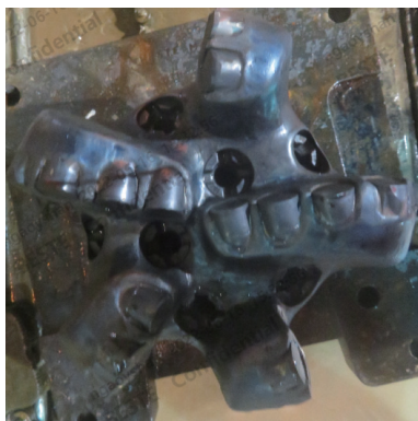
图5 出井钻头磨损情况
