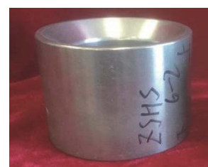
图 4 石墨烯增强铝基复合材料制备的可溶球座
