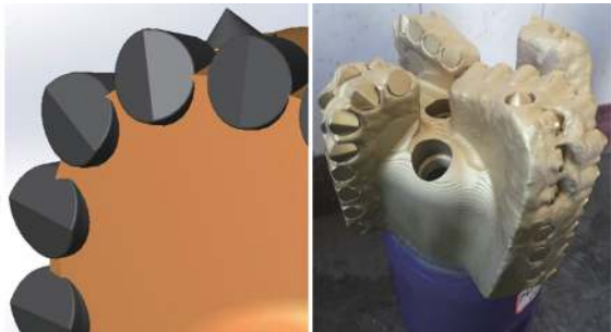
图 3 适用于灰质泥岩的脊形齿 PDC 钻头切削齿形状及分布
