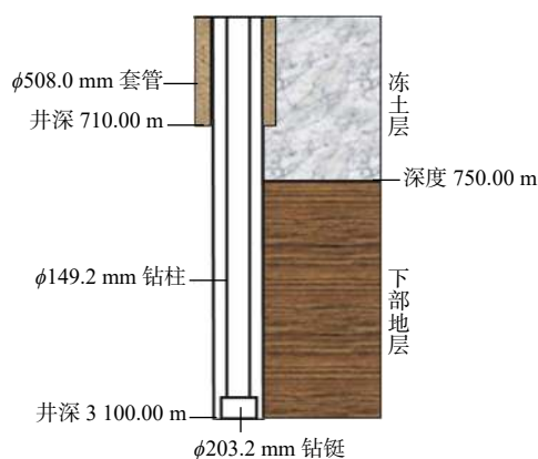
图8 井身结构示意图
