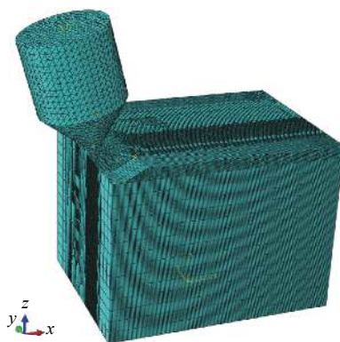
图1 锥形齿破岩模拟模型
