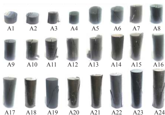
图 4 三轴压缩试验中的岩样破坏形态
