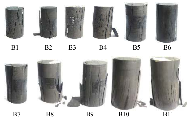
图7 单轴压缩试验得到的岩样破坏形态
