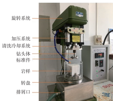
图1 岩石研磨性试验装置
