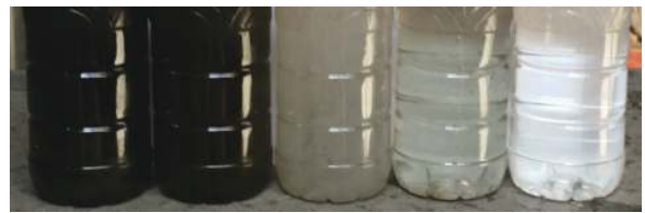
图 5 反循环洗井中返出液的颜色变化
