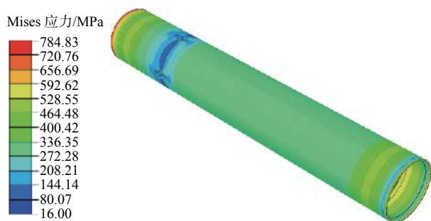
图4 电控外套筒应力分布云图
