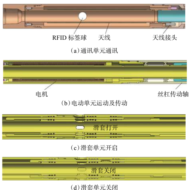
图 2 RFID 智能滑套部分单元功能
