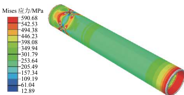
图5 滑套外套筒应力分布云图
