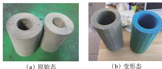
图 2 不同状态的形状记忆材料试样
