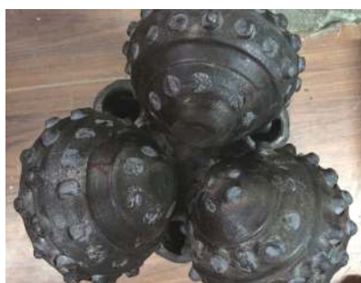
图 1 哈山 101 井火山岩地层牙轮钻头出井形貌
