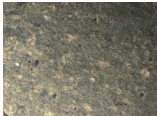
(b) 体视显微镜观察结果(高强微弹水泥石,放大150倍)
