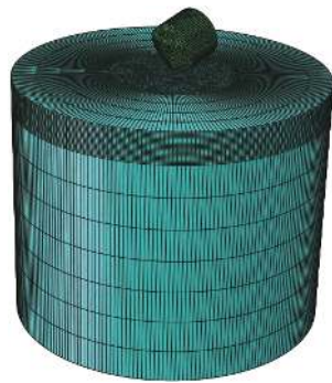
图 3 单 PDC 切削齿垂直压入岩石的模型
