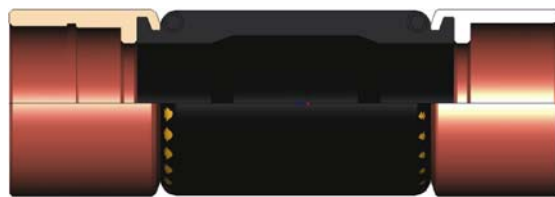
图11 上封隔器的封隔胶筒
