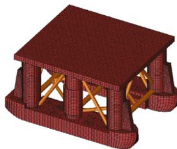
图1 基于 ANSYS-AQWA 的半潜式平台湿表面模型
