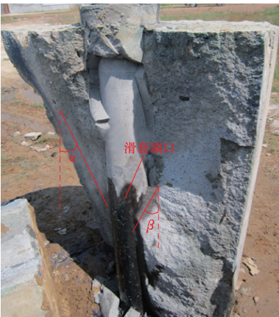
图 7 带角度端口压裂后的裂缝形态
