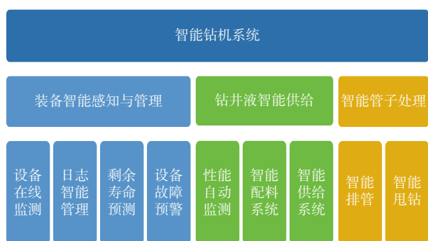
图 7 海洋智能钻机系统主要架构
