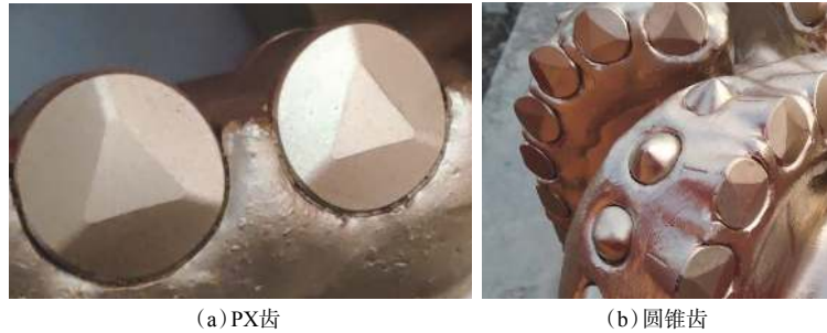
图 3 异形齿 PDC 钻头的 PX 齿与圆锥齿
